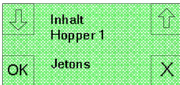
Mit der Option "OK" kann die getroffene Wahl bestätigt und auf die folgende Bildschirmseite übergegangen werden. Hier kann der Wert des einzelnen, im Hopper enthaltenen Stücks eingestellt werden, der zwischen 10 Cent und 50 Euro liegen muss.
