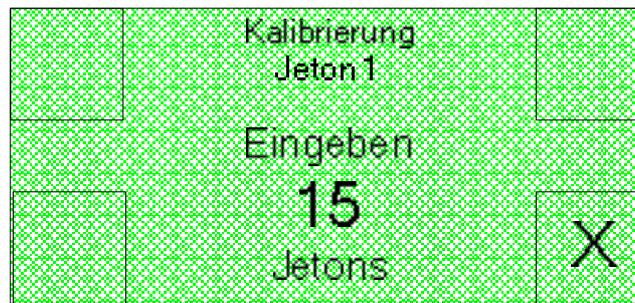
Am Ende des Vorgangs meldet das Display die erfolgte Einstellung und das Gerät ist folglich in der Lage, den für die Eichung verwendeten Jetontyp anzunehmen. Auf dieselbe Weise kann der Münzprüfer mit der Option **JET 2** auf der Bildschirmseite "Konfiguration Eingabe Jetons" auch für einen zweiten Jetontyp eingestellt werden.
