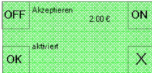
Mit den Tasten "ON" und "OFF" werden die auf dem Display angezeigten Münzen oder
