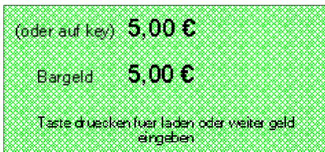
Das Display zeigt ein Beispiel. Auf der ersten Zeile wird der auf dem Schlüssel oder der Karte vorhandene Kredit angegeben, während auf der zweiten Zeile das eingeführte Bargeld angezeigt wird. Um das eingeführte Bargeld auf das Cashless-Zahlungssystem hochzuladen, ist irgendeine der 4 Tasten in den Displayecken zu drücken oder einige Sekunden abzuwarten.
