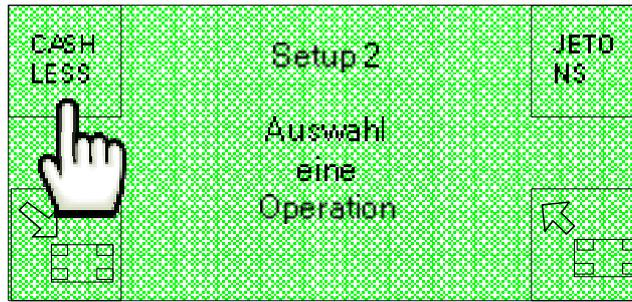
Jetzt wird die folgende Bildschirmseite angezeigt, über die der Zugriff auf die Konfiguration der Lesegeräte und der Automaten der Cashless-Systeme erfolgt und auf der die mit diesen Einrichtungen verbundenen Rabatt-Aktionen eingestellt werden können.
