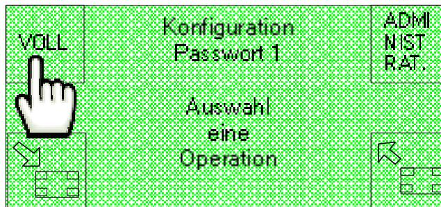
Auf diese Weise kann auf die folgende Bildschirmseite übergegangen werden, auf der die vier numerischen Schriftzeichen des Passwortes für den vollen Zugriff auf alle Funktionen eingegeben werden können.
