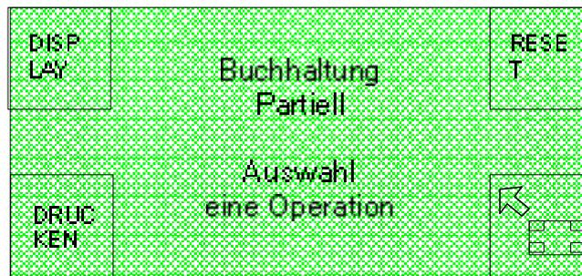
Durch die Auswahl der Option **DISPLAY** wird auf dem Display die Liste mit den Beträgen der eingeführten Münzen, Banknoten und Jetons, der ausgegebenen Jetons und Bonus und der verkauften Cashless-Systemen angezeigt, die alle nach Typ aufgeteilt sind, sowie die mit dem POS-System und den Cashless-Geräten durchgeführten Zahlungen. Zum Scrollen der Liste sind die beiden Tasten auf der rechten Seite des Displays zu benutzen, die den Optionen :
