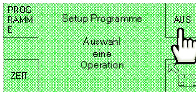
Es wird die folgende Bildschirmseite angezeigt, auf der entsprechend der angeschlossenen Waschanlage mit den Tasten "ON" und "OFF" das binäre Signale aktiviert oder deaktiviert werden kann (wodurch folglich das parallele Signal deaktiviert oder aktiviert wird).
