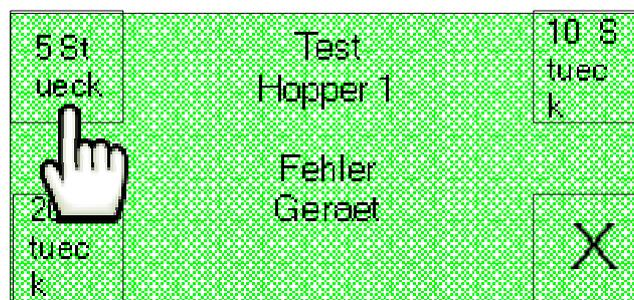
Bei einer Funktionsstörung der Hopper wird die Meldung “**Geraete Fehler**“ auf dem Display angezeigt.
